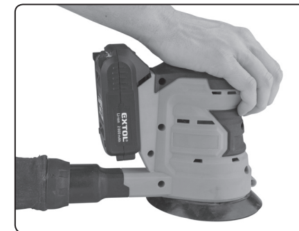
Obr. 5, vedenie brúsky po brúsenom povrchu rukou
